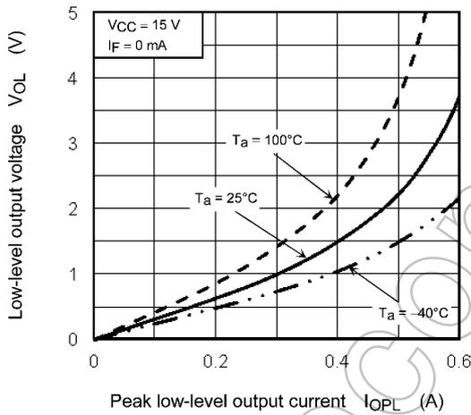
**Fig. 12.2.9  $V_{OL} - I_{OPL}$**
