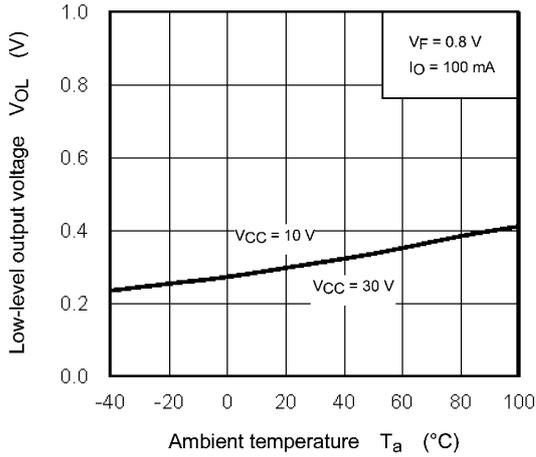
**Fig. 12.2.7  $V_{OL} - T_a$**
