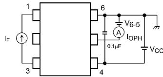
Fig. 12.1.1  $I_{OPH}$  Test Circuit
