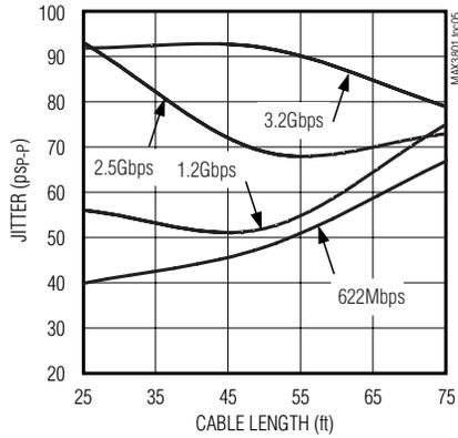
**EQUALIZER RESIDUAL JITTER vs. CABLE LENGTH (CATEGORY 5E – TWISTED PAIR) INPUT LEVEL OF 700mVp-p**
