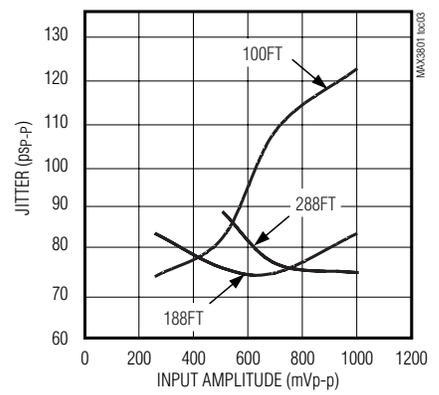
**EQUALIZER RESIDUAL JITTER vs. CABLE LENGTH (RG59 – 75Ω COAXIAL CABLE – SINGLE-ENDED) INPUT LEVEL OF 500mVp-p**
