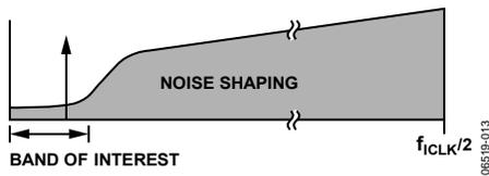
Figure 24.  $\Sigma$ - $\Delta$  ADC, Noise Shaping
