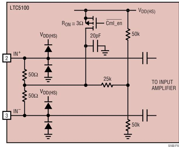
Figure 10. Equivalent Circuit for the IN<sup>+</sup> and IN<sup>-</sup> Pins
