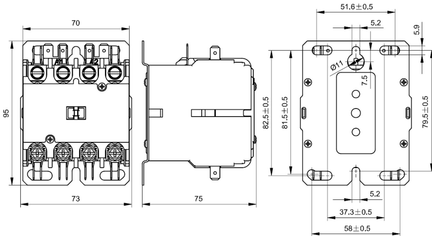
4 Pole Contactor (Standard Thermoset, 25-40FLA)
