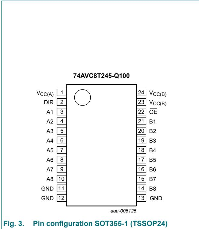
Fig. 3. Pin configuration SOT355-1 (TSSOP24)
